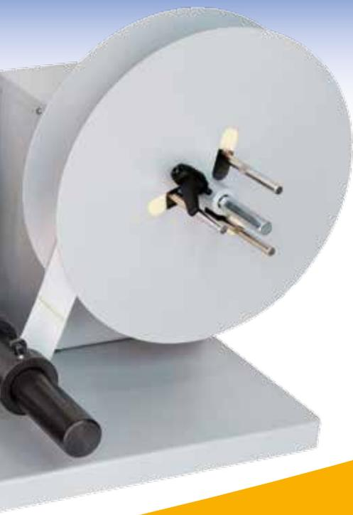
Nella funzione di controllo una fotocellula permette oltre che il conteggio delle etichette, di controllare la presenza delle etichette e segnalarne la mancanza con la possibilità di arresto per il riposizionamento. L'operazione avviene senza nessun settaggio ma tramite la centralina di controllo che autoapprende la lunghezza dell'etichetta. Per etichette trasparenti è disponibile una fotocellula a ultrasuoni.
